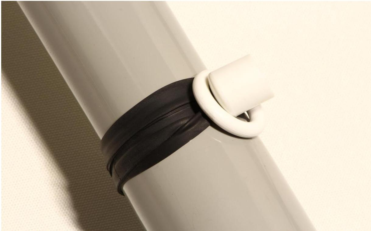
Die Demontage ist denkbar einfach: Den Bolzen wieder durch den Ring ziehen und sobald man keinen Zug mehr auf die Schelle ausübt, löst sie sich ganz von selbst. Gut aufbewahren, denn bei der nächsten mobilen Funkaktion brauchen wir sie ja wieder 😊.
